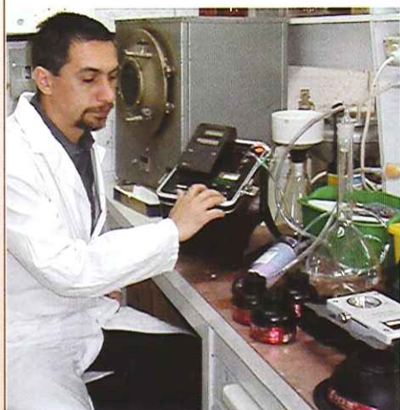
המהנדס א. פרבלוב מהמכון הלאומי לחקר הבנייה מודד מאפייני ראדון בעמצאות אלפא-ספקטרוטר ואלקטריטים
