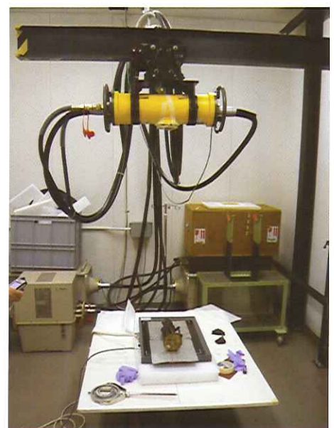
תמונה 4: בדיקת פסל באמצעות רדיוגרפיה דיגיטאלית, הערכות המעבדה
