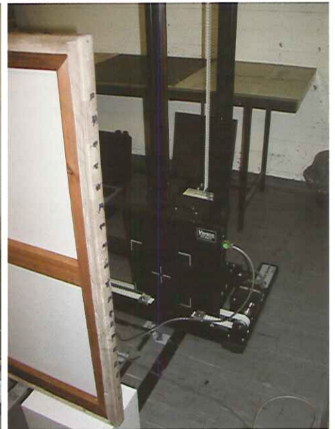
תמונה 9: תמונת שמן נבדקת באמצעות מערכת רנטגן ניידת המורכבת על מסועים אוטומטיים מסונכרנים
