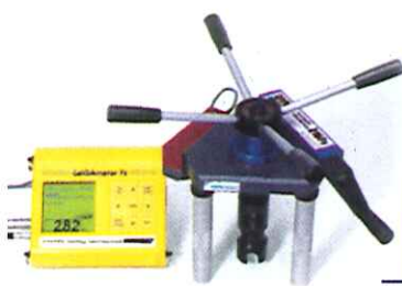
מיכשור נייד לבדיקות NDT בבטונים (פטיש Pull-Off, Schmidt, איתור קורות זיון, קורוזיה ועוד)
