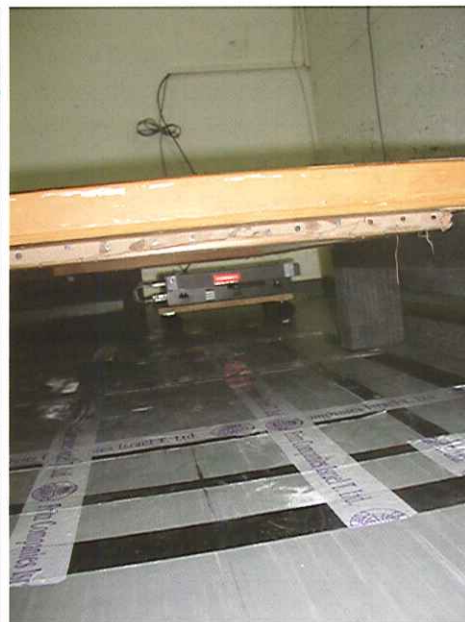
תמונה 10: רשת מסומנת על הרצפה והפאנל השטוח ומקור רנטון רציף מוסעים לאיזור השיקוף הרצוי
