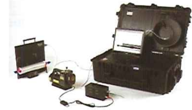
זמן חשיפה עם מקור מסוג איזוטופ הוא כ-3 דקות לעומת 30 שניות בשילוב מערכת foX-Rayzor
