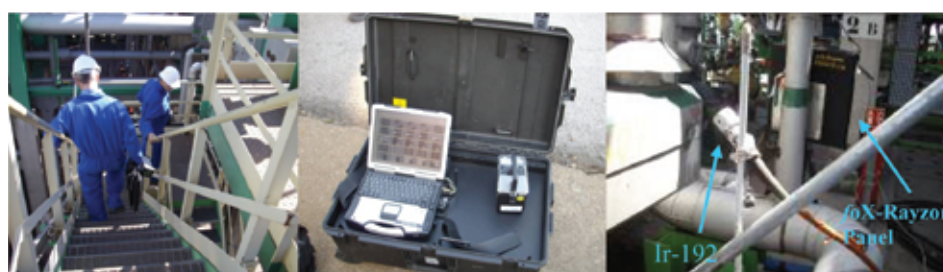
תמונה 4: עבודה עם מערכת ניידת של וידיסקו בשטח בית הזיקוק
