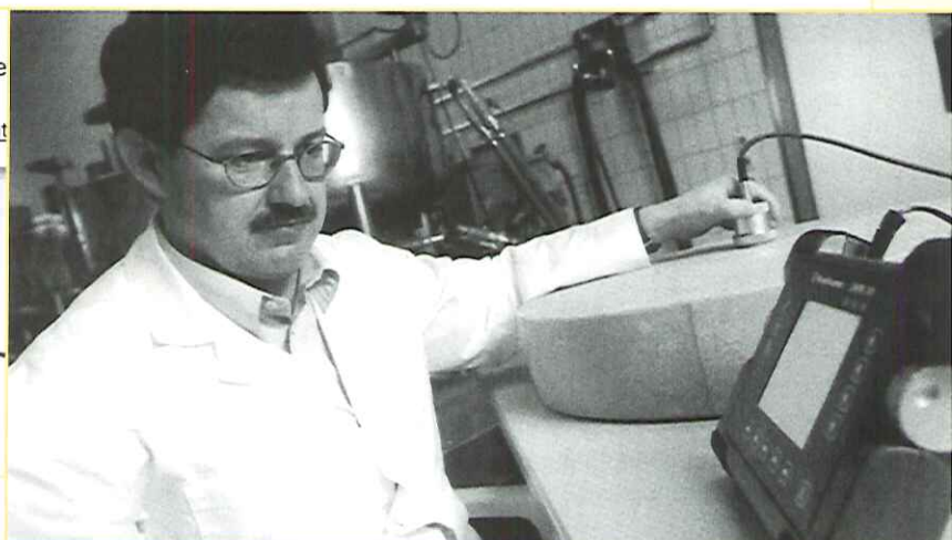
כמו בבדיקות ידניות בתעשייה: ברונו אלברט, מהמכון לחקר משק החלב, מאזין להבשלתה של גבינה
