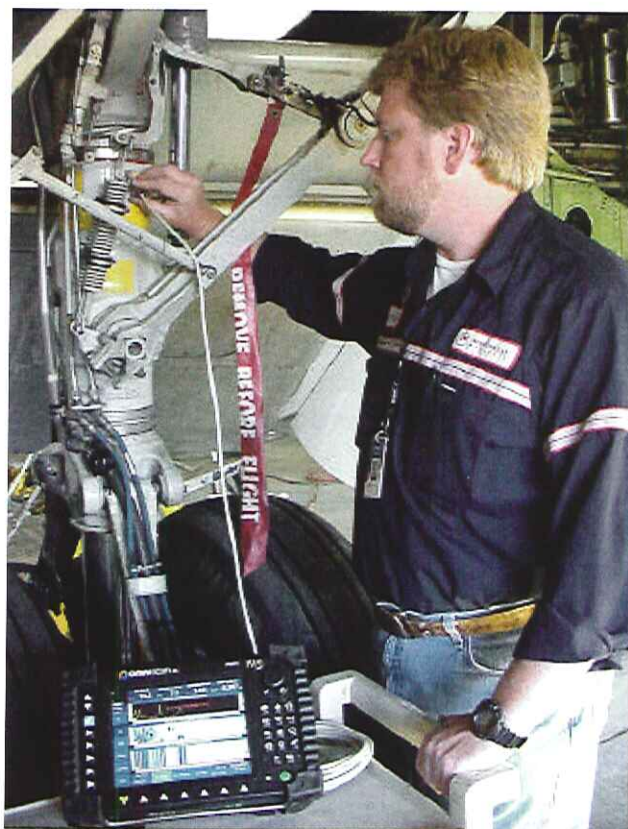
תמונה 3: בדיקת כן נסע באמצעות מערכת Phased Array ניידת
