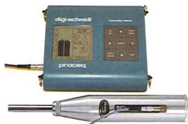
מיכשור נייד לבדיקות NDT בבטונים (פטיט Pull-Off, Schmidt, איתור קורות זיון, קורוזיה ועוד)
