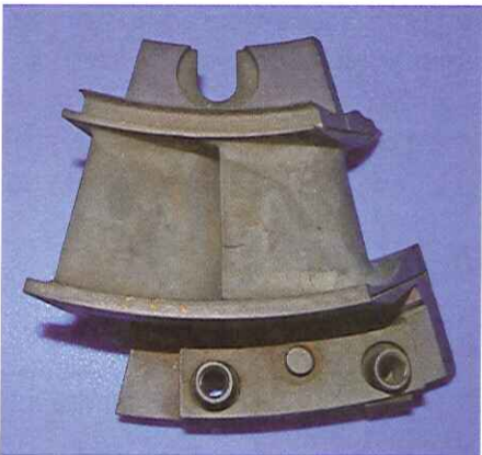
רכיבים קריטיים במנוע סילון: להבי טורבינה (למעלה), מעטפת תא שריפה (במרכז), מכוני טורבינה סטטיים (למטה). מנוע מטוס האפצ'י. צילם: עוז גולן
