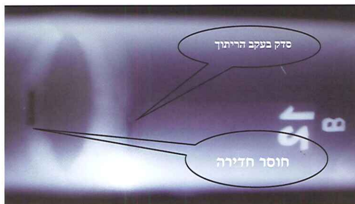
תרשים 9: רדיוגרפיה של ריתוך עם סדק בעקב הריתוך וחוסר חדירה מסומנים.
