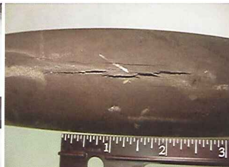
תמונה 1 - דוגמא לסדק (תמונה מימין) ופריצה (תמונה משמאל), שנגרמו בנתך P91 עקב טיפול תרמי לא הולם
