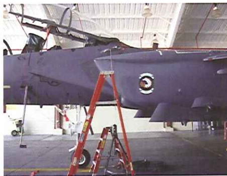
פאנל מסוג Flat Fox-17 של וידיסקו משמש לבדיקת מטוס קרב F-15 על ידי חיל האוויר האמריקאי
