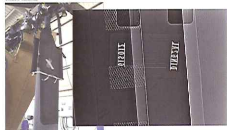
מערך רדיוגרפיה דיגיטלית בשדה המצוייד בפאנל שטוח מסוג RayzorXPro של וידיסקו משמש לבדיקת להבים של מסוק אפאצ'י - לידו צילום הרנטגן המקביל
