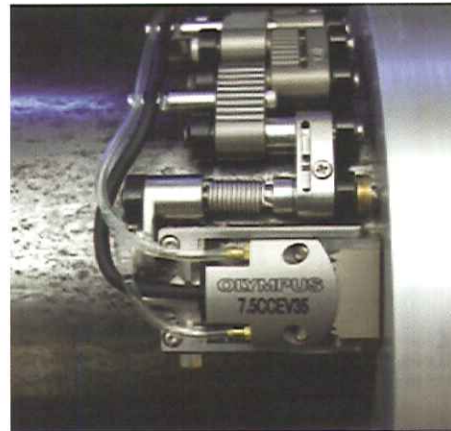
תרשים 3: סורק קוברה בבדיקת ריתוך של צינור לרכיב בגישה חד-צדדית.
